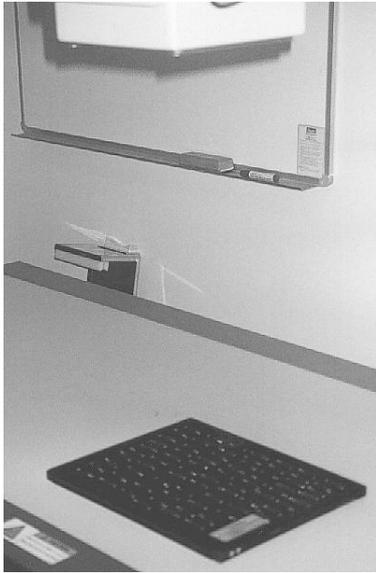
Fig. 2- 3. Prueba de contacto película / pantalla, usando presillas para papel como herramienta de prueba.
